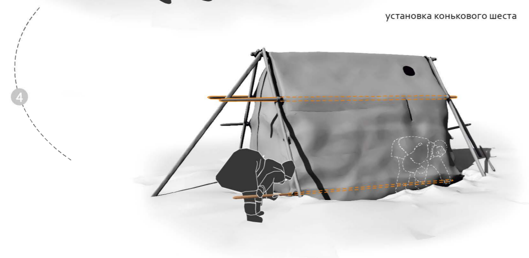
установка боковых поддерживающих шестов
